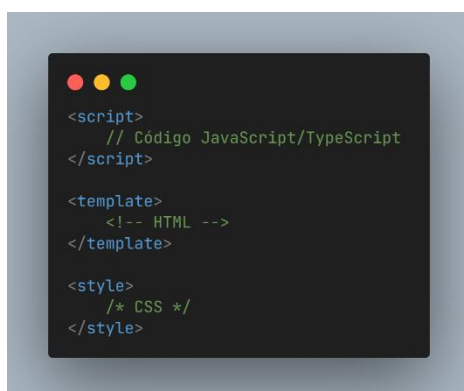
Ilustración 2. Esquema "Single-File-Component" en Vue
