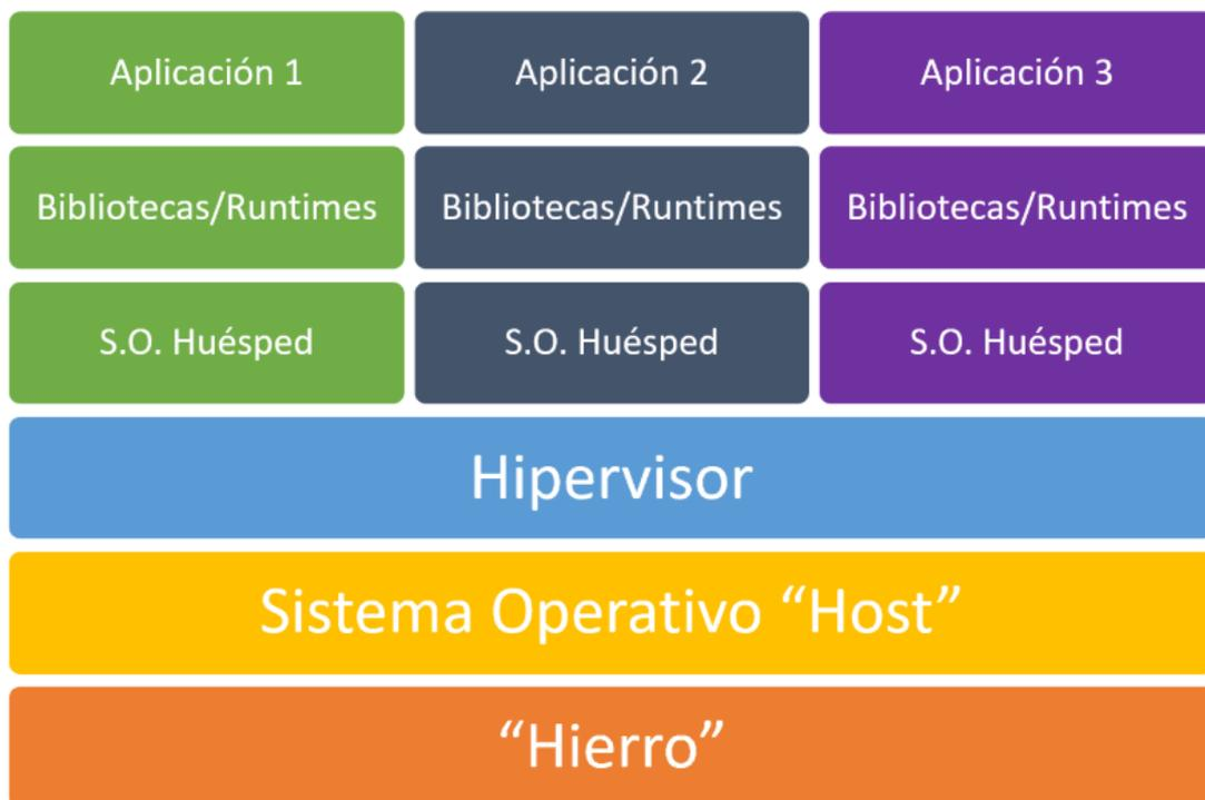
Ilustración 4: Esquema de una máquina virtual
