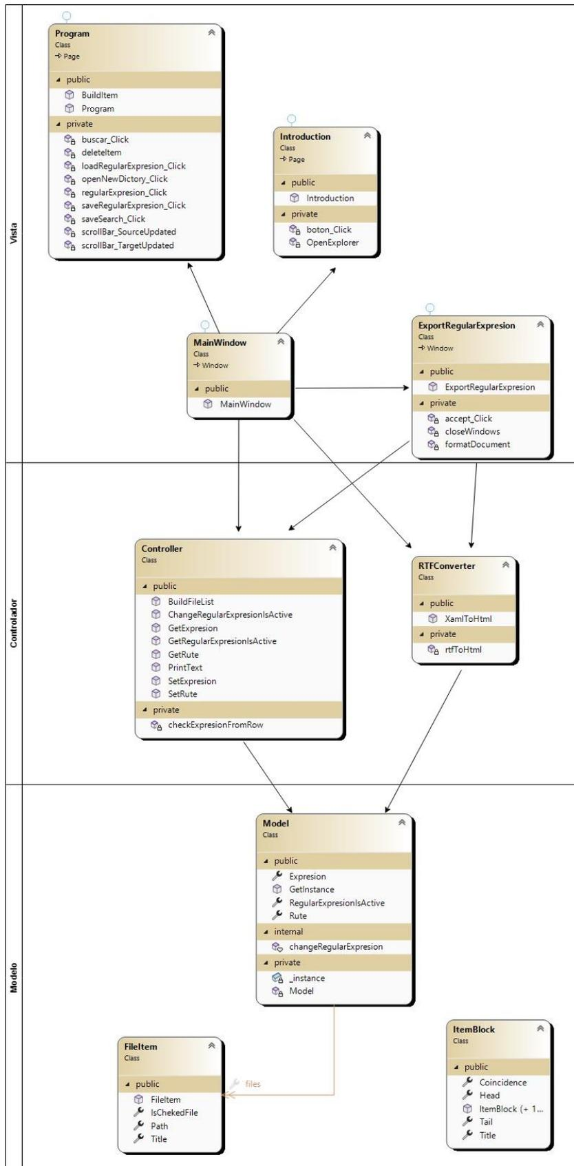
El diagrama anterior se corresponde con el diagrama de clases utilizado en el proyecto. En él se constituyen las tres capas usadas, siguiendo el patrón arquitectónico Modelo-Vista-Controlador (MVC).
