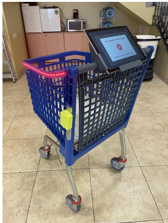
Figura 21. Dispositivo en estado pago no posible
