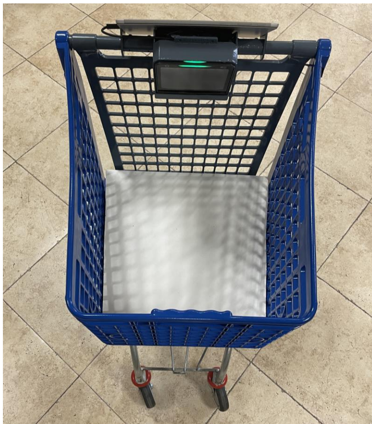
Figura 12. Sensor de peso incorporado al carro
