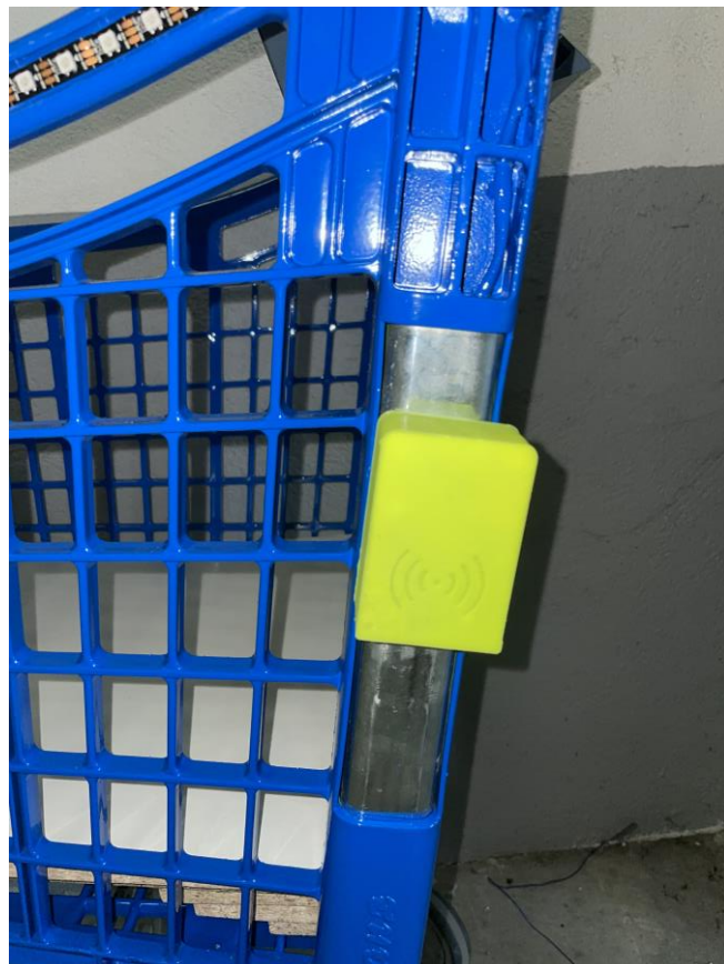
Figura 14. Lector RFID incorporado al carro
