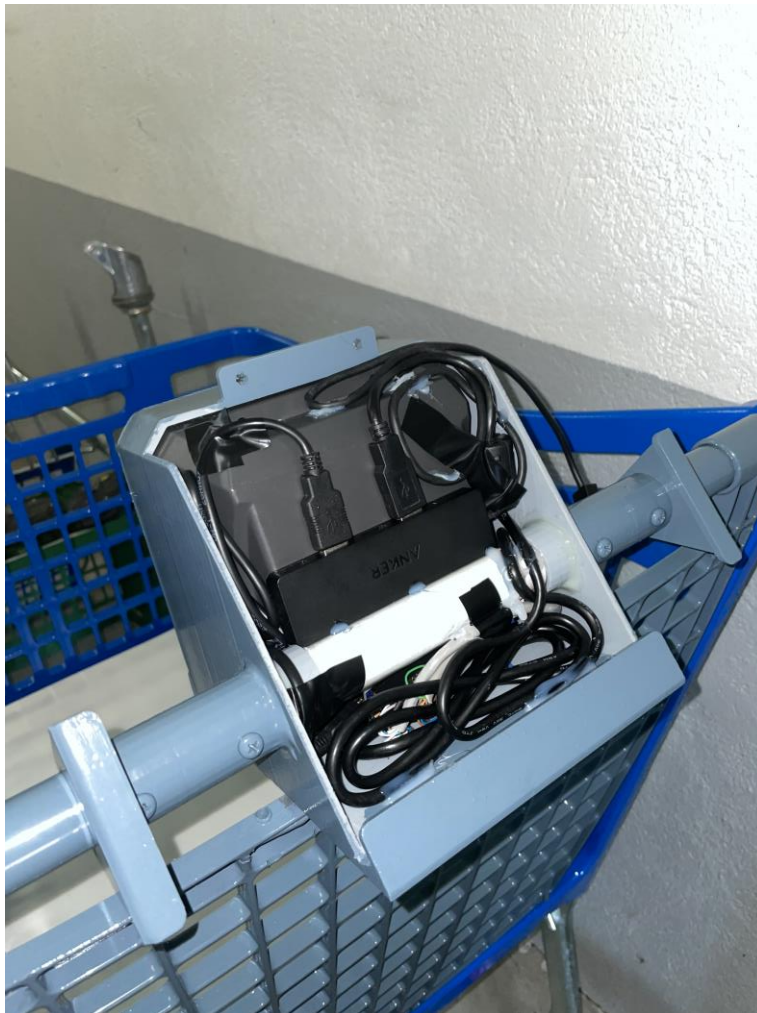
Figura 8. Soporte principal incorporado al carro
