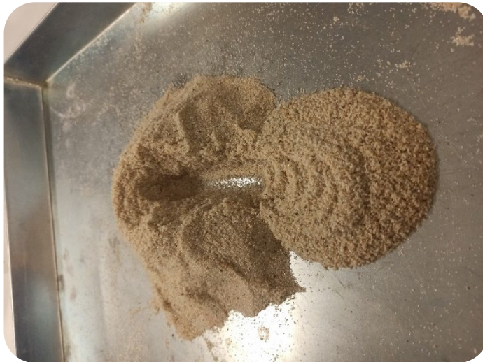
Figura 3: Prueba de la relación correcta entre arena de sílice y aceite de silicona para fabricar arena cinética
