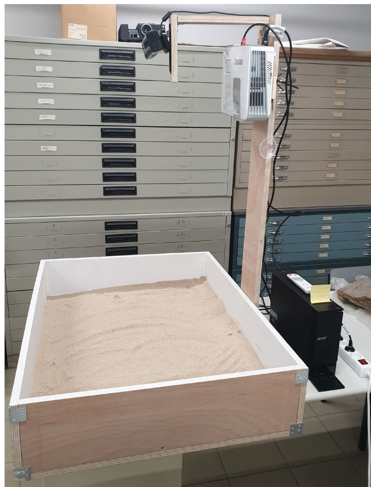
Figura 5: Estructura completa de la Sandbox.
