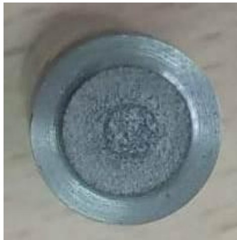
Figura 5. Superficie de fractura de una pieza de acero tras haber sido sometida a cargas de fatiga en la ETS de Ingeniería Industrial de Béjar (Salamanca)
