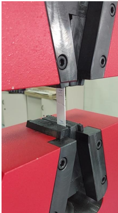
Figura 3. Muestra de aluminio ensayada a tracción
