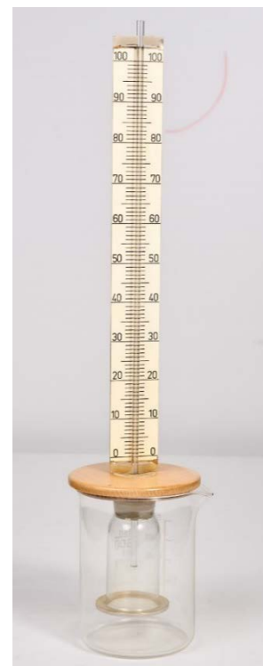
Figura 1. Osmómetro de Dutrochet, de la casa Leybold. La vasija no es la original.
