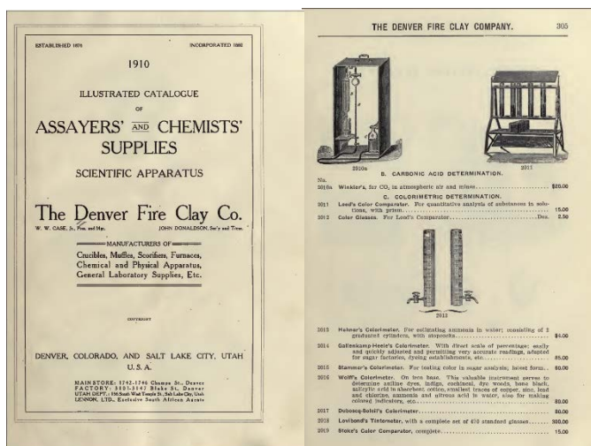
Fig.2. Catálogo visual de la Compañía "The Denver Fire Clay" 3 . Página donde se referencian las buretas de Hehner y el Colorímetro de Gallenkamp-Heele (aunque desgraciadamente no se muestra su fotografía).
