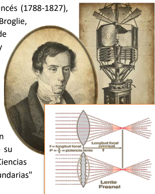
Figura 2. Lente de Fresnel que reproduce la curvatura de la superficie de la lente gruesa en secciones, manteniendo la misma longitud focal.
