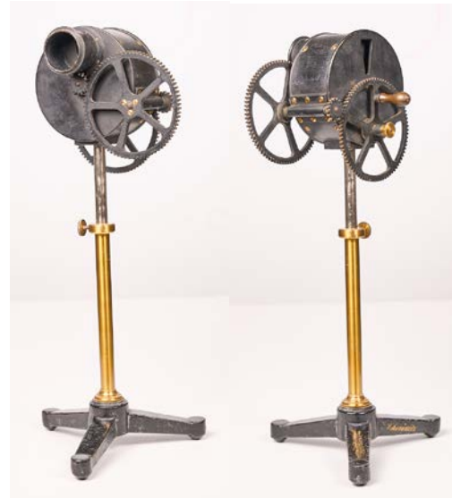
Figura 3. Fosforoscopio de Becquerel de Max Kohl
