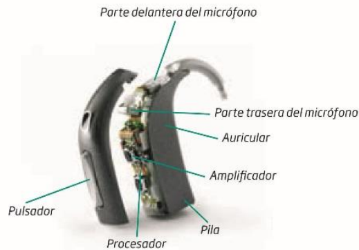
Figura 11. Partes de un audífono.
