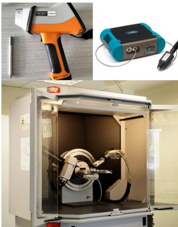
Figura 5. Técnicas empleadas en la caracterización de las fases sólidas recopiladas en los diferentes experimentos. Arriba a la izquierda, pistola de FRX (HITACHI). A la derecha el espectrorradiómetro ASD-FieldSpec4Hi-Res. Abajo, el difractómetro BRUKER D8 Advance.
