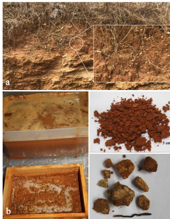
Figura 2. Ejemplo de extracción de muestras en un perfil cercano a Villa Maruja de arcillas o arenas rojas terciarias, y procesado con criba, extracción de inclusiones no deseadas y decantación.
