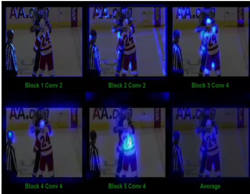
FIGURA 5.3: Mapas de calor generados mediante Grad-CAM aplicados sobre la última capa convolucional de cada bloque de la red VGG-19, junto con el mapa promedio resultante. Se utiliza como entrada un fotograma representativo de un vídeo del dataset Hockey Fights .
