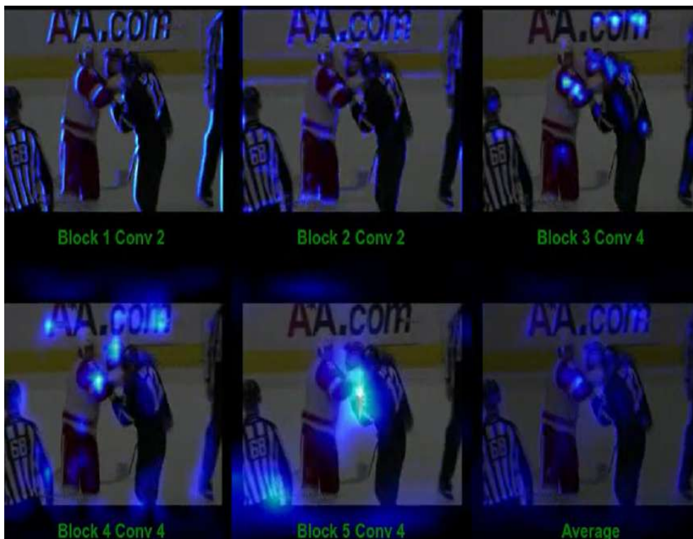
FIGURA 5.6: Resultado de GradCAM para la última capa convolucional de cada bloque de VGG-19 y el promedio de mapas de calor, para el frame de un vídeo del dataset Hockey fights . Las zonas resaltadas son aquellas sobre las que la CNN presta más atención.
