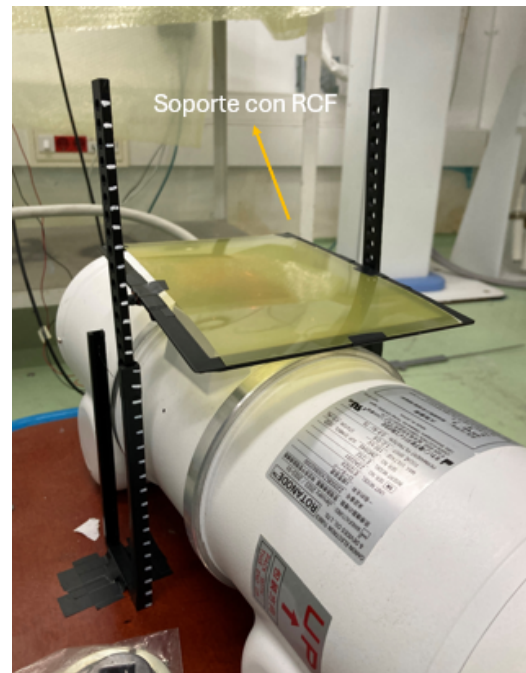
Figura 3.4: Soporte utilizado para irradiaciones a mayores distancias de la ventana del tubo.
