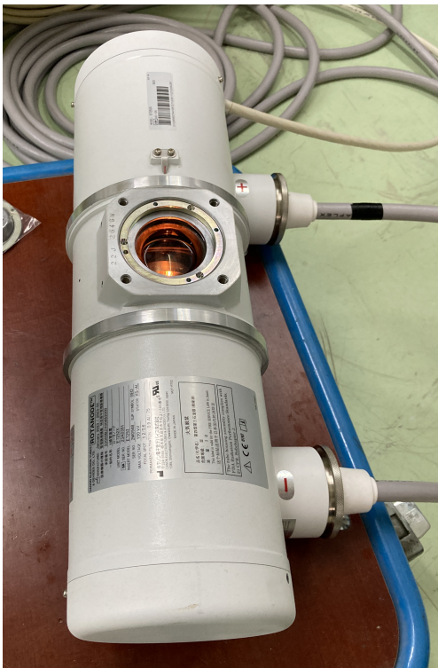
Figura 3.1: Tubo de Rayos - X Toshiba E7252X con la ventana de salida hacia arriba.
