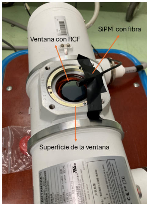
Figura 3.3: Película en la ventana del tubo junto con SiPM unido a la fibra y colocado en la superficie del tubo.
