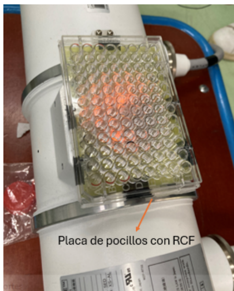
Figura 3.5: Placa de pocillos con película en la parte inferior
