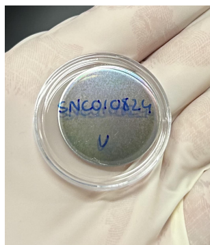
Figura 21: Fuente de medida recubierta con una película de VYNS
