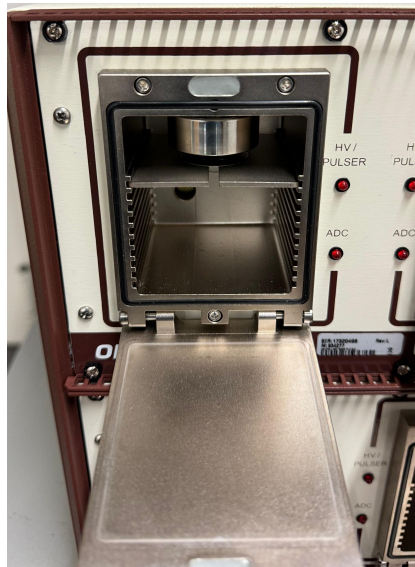
Figura 4: Cámara \alpha abierta
