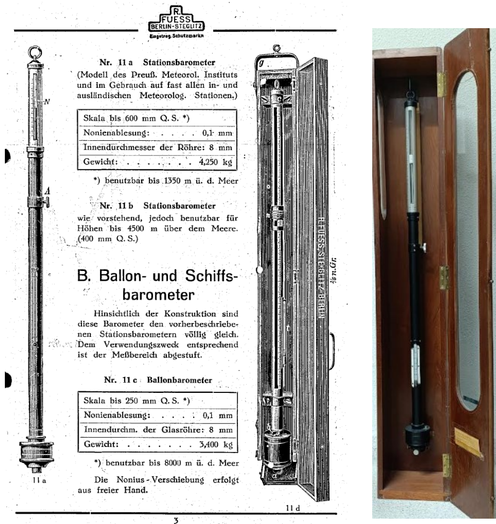
Figura 3. Figura 4. Anuncio de Barómetros de Mercurio estándar (Quecksilber-normal-Barometer) de 1926 de la empresa R. Fuess donde se puede apreciar el Barómetro de Estaciones Meteorológicas (Stationsbarometer), izquierda. Barómetro de la Colección de Físicas de la USAL, derecha.
