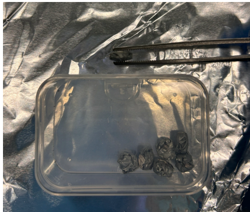
Figura A.10: Comparación de muestra correctamente prensada con muestras que atascaron el carrusel del EA. Imagen propia.
