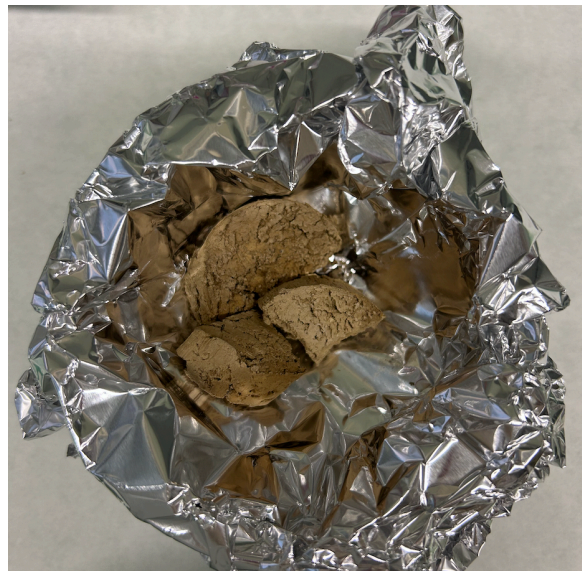
Figura A.1: Izquierda, muestras en papel de aluminio introducidas en crisol de secado durante su estancia en estufa. Derecha, muestra seca. Imágenes propias.
