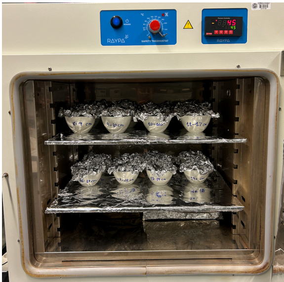
Figura A.1: Izquierda, muestras en papel de aluminio introducidas en crisol de secado durante su estancia en estufa. Derecha, muestra seca. Imágenes propias.
