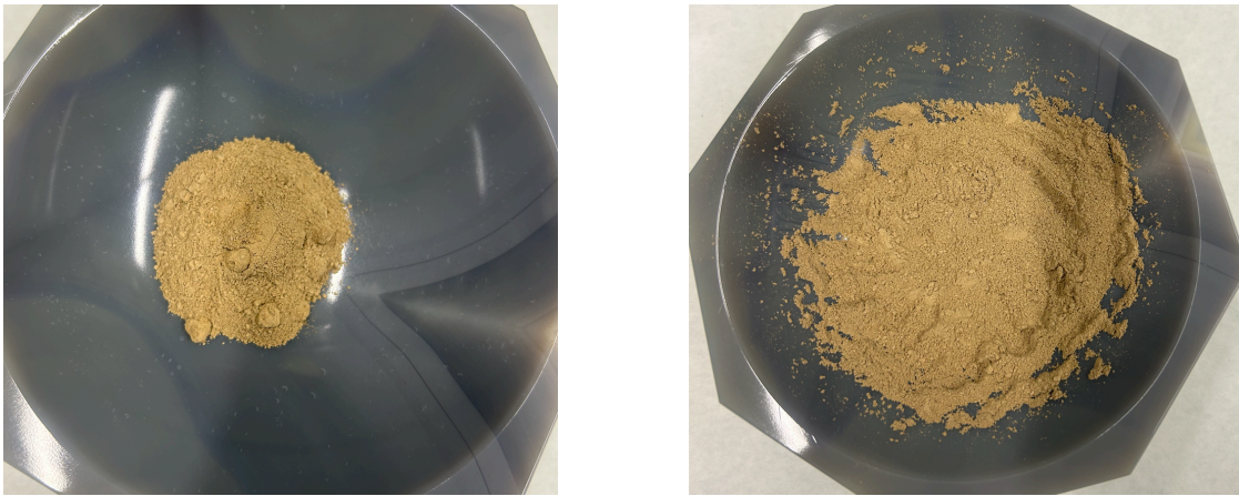
Figura A.15: Izquierda, fuente marcada seca sin disgregar. Derecha, fuente marcada seca disgregada. Imágenes propias.
