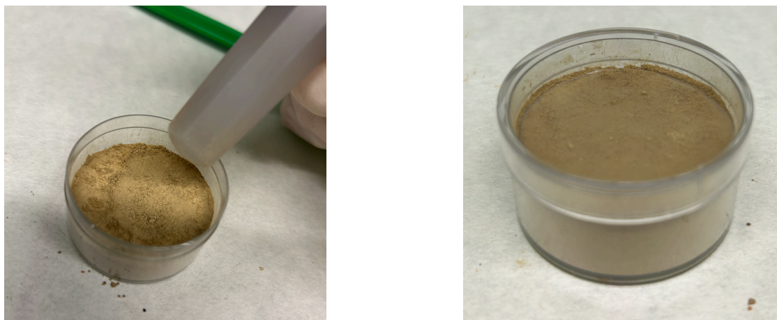
Figura 5.5: Proceso de llenado y compactación de masa dentro de la geometría C11. Imágenes propias.
