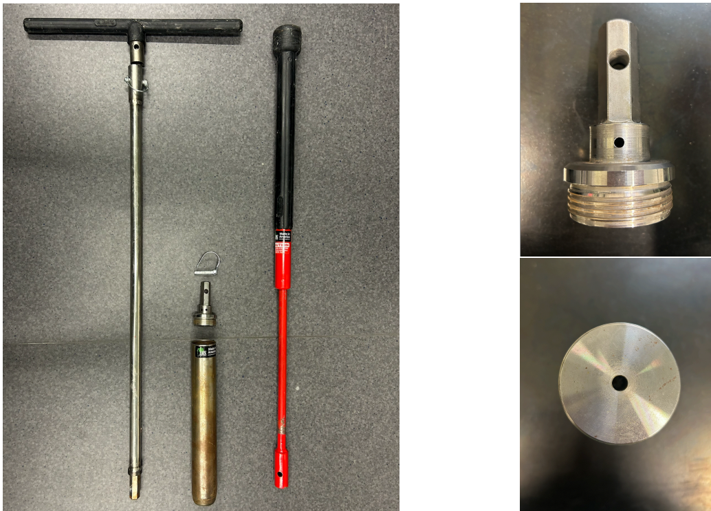
Figura 5.3: A la izquierda equipo de muestreo completo, cabezal gravitatorio (rojo), cabezal rotatorio (T), vaina de acero que contiene el sedimento, cierre y válvula de acero. Derecha, detalle del cierre se puede ver el orificio de salida de agua que conecta la vaina con el exterior. Imágenes propias..
