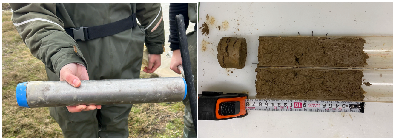
Figura 5.4: A la izquierda base de acero del muestreador, en el interior se encuentra el tubo de PVC que contiene el sedimento. A la derecha muestras de sedimento hecha la hemisección y los tres centímetros que quedaron en la parte final del muestreador. Imágenes propias.
