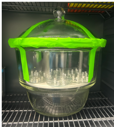
Figura A.7: Izquierda, muestras en el interior del desecador. Derecha, desecador lleno con HCl y sellado en el horno. Imágenes propias.
