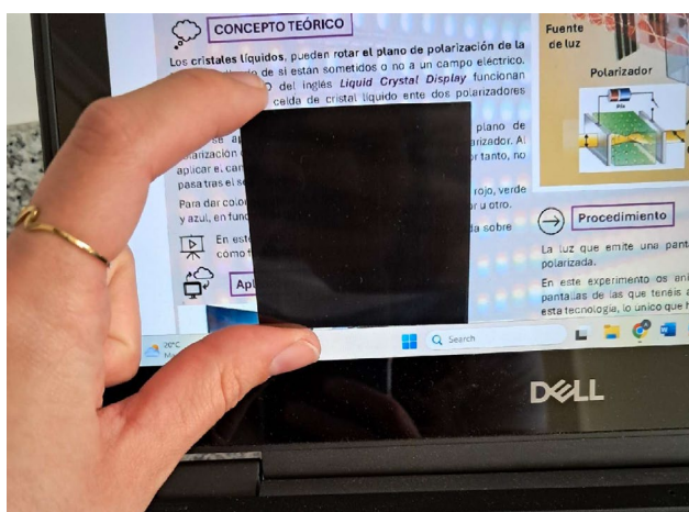
Figura 2: Fotografía de uno de los experimentos realizados por los alumnos (Experimento 3: Pantallas LCD), en el centro de la imagen se muestra el polarizador lineal. A la vez se observa que la luz de la pantalla no se transmite a través del elemento óptico, efecto que se pretende observar con el experimento.
