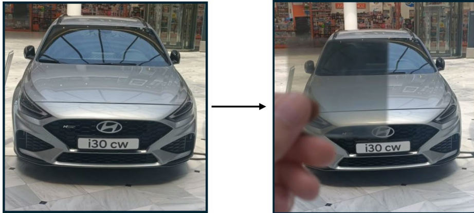
Figura 3: Fotografías presentadas por uno de los estudiantes participantes en el proyecto para demostrar la realización del Experimento 1: Eliminar reflejos con un polarizador lineal. Se observa claramente que el alumno ha comprendido qué es lo que se le pedía ya que la imagen de la derecha muestra como el reflejo producido en el capó del coche se elimina por la acción del polarizador.
