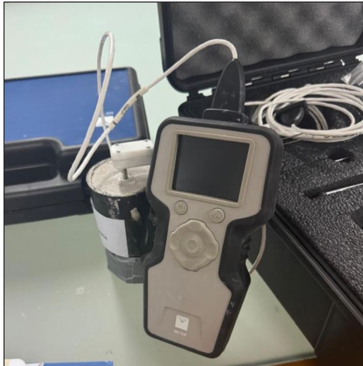
Figura 6. Medición de la conductividad térmica con equipo TEMPOS.
