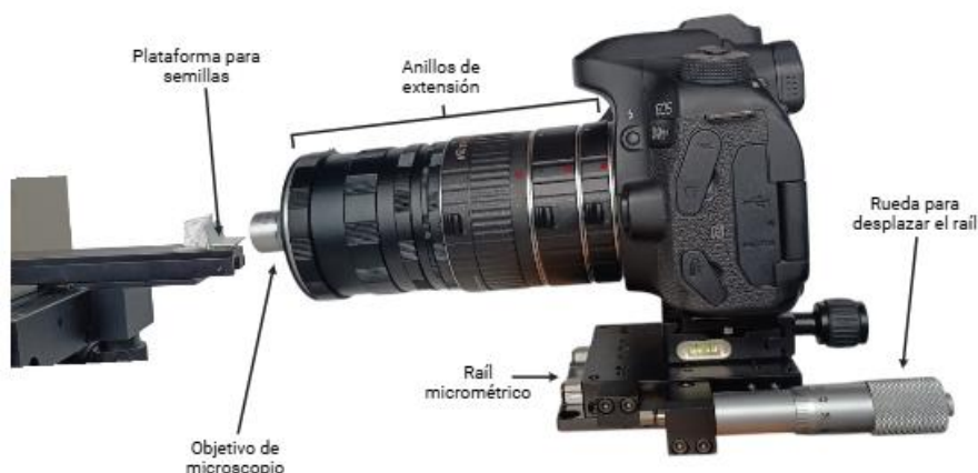
Figura 2. Disposición del equipo fotográfico para la realización de las fotos, con sus partes correspondientes para poder comprender el funcionamiento de esta técnica. Imagen de elaboración propia.
