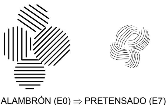
Fig. 2.11. Cambios en colonias y láminas de perlita con el trefilado (sección transversal).
