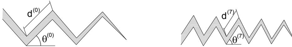
Fig. 4.158. Esquema de las fisuras, alambre E0 (izqda.) y acero de pretensado E7 (dcha.).
