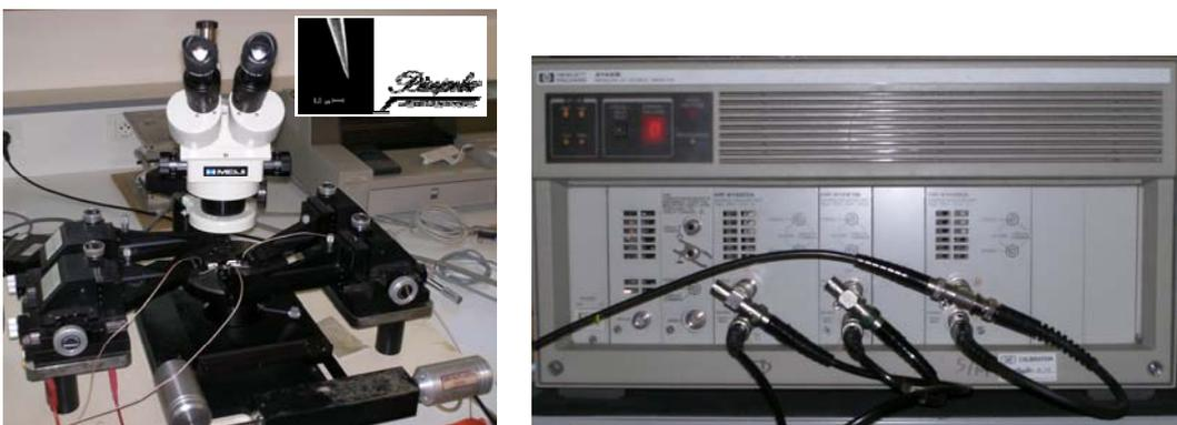
**Figura I.32.** Imágenes del banco de medida con puntas *Picoprobe* y de la fuente de alimentación de HP Agilent 4142B usadas en la caracterización estática de nanodispositivos.
