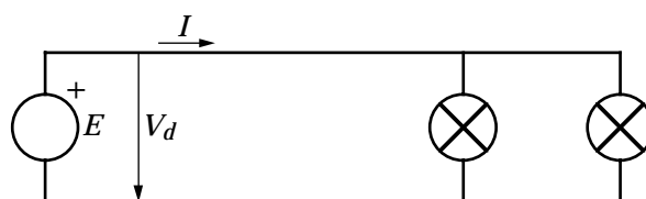
Figura 2.- Alimentación de lámparas de corriente continua “a tensión constante”.
