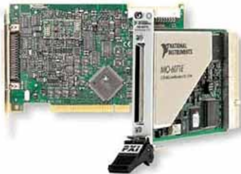
Figura 4.- Tarjeta PCI 6071E de National Instruments con la que se realizará la medida de las señales eléctricas.
