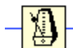
Figura 54.- Instrucción llamada Espera Hasta el Siguiente Múltiplo de ms ( Wait Until Next ms Multiple ).
