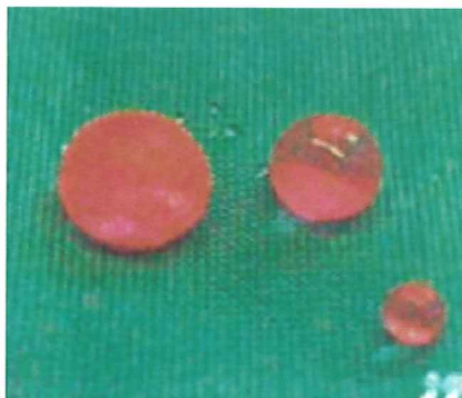
Figura 16. Las propiedades autolimpiadoras e hidrófobas de los textiles fabricados por el procedimiento nanotecnológico denominado Effet-Lotus® (© V.v.Arim-ITV Denkendorf) 40 .
