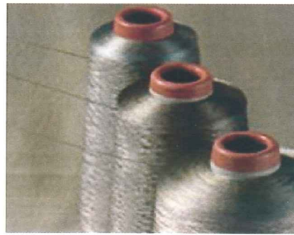
Figura 7. Hilo Protex Ag (Carolina Silver Technologies) recubierto de plata 26) .
