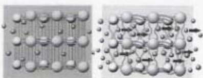
Figura 9.- Membrana del material Diaplex por debajo de la temperatura de activación (izquierda) y por encima de ésta (derecha) [29].
