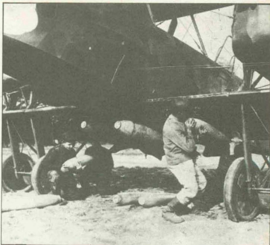
Soldados alemanes cargando bombas en un Gotha GV. Podía arrojar un máximo de 1.000 libras de metralla durante la Primera Guerra Mundial.
