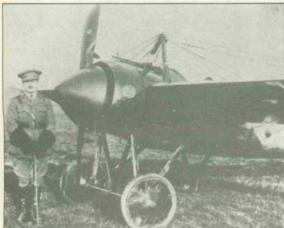
Avión francés de combate Morane-Saulnier (1915), con capa protectora de la hélice.
