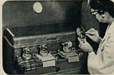
El desgaste que pueda producirse por el uso, se valora en ensayos de resistencia ejecutados en un abrasímetro.
