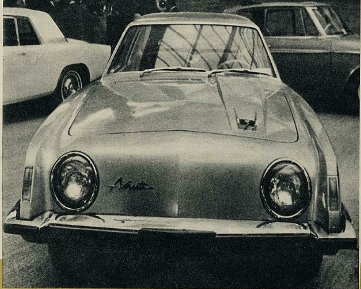
Potencia fiscal, 27 CV; real, 200 CV. 8 cilindros en V, válvulas en cabeza. Frenos a disco en las ruedas delanteras. Velocidad máxima, 200 Km/h. Precio: 30.600 NF.
