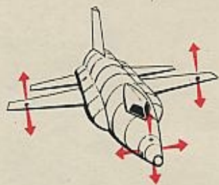
Los chorros de vapor se usan en varias combinaciones para cambiar la posición del aparato cuando está fuera de la atmósfera. Los del morro controlan todos los movimientos verticales y los de las alas, los laterales.
