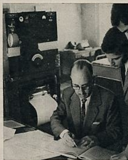
Las señales del radiosonda son captadas por el receptor de la izquierda, que las imprime automáticamente en un papel especial. En la foto, un técnico calcula el estado de las sucesivas capas de aire.
