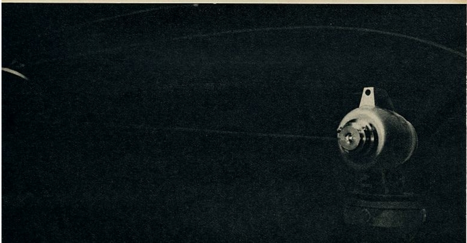
Un finísimo rayo de luz roja se proyecta sobre una plancha de acero de tres milímetros de espesor (fotografía inferior), agujereándola instantáneamente. En la foto superior se aprecia el chisporroteo producido al incidir el haz luminoso sobre la plancha. Los rayos del «laser» pueden llegar a perforar las sustancias más resistentes.
