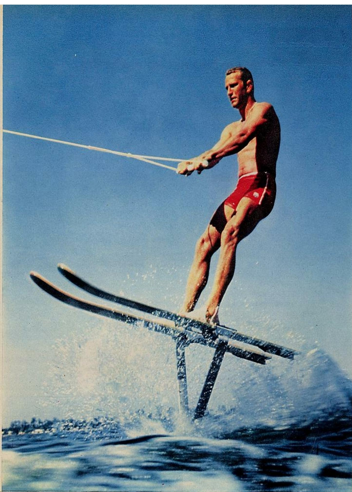
Un esquí con una quilla en forma de V, con profundas aristas longitudinales, que recorren toda la largura del fondo. Este esquí, con «hidrofil», remolcado también por un helicóptero puede lanzar a su pasajero por encima del agua, en un vuelo semejante al de las aves zancudas.
