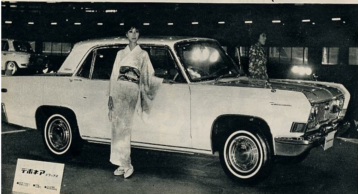
He aquí el «Debonair», con motor de 2.000 c.c., capaz para seis personas. Su velocidad máxima es de 155 kms. por hora y su precio en fábrica equivale a 208.000 pts.
