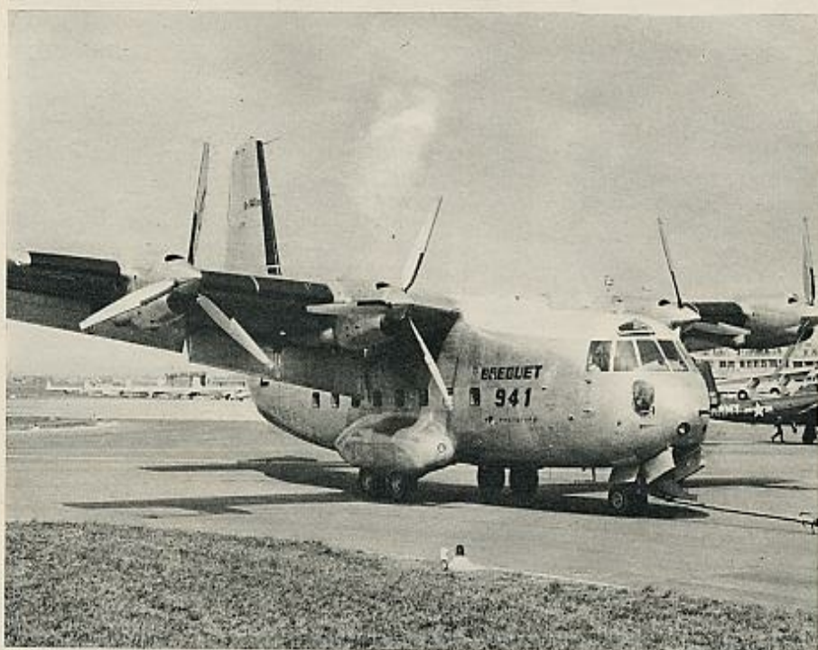
Arriba, el «Breguet 941»; aterriza en 200 metros y despegue en 150. Abajo, el más grande avión del mundo, el soviético «Antonov 22»; carga 80 toneladas y transporta 750 pasajeros; toma tierra en 500 metros.
