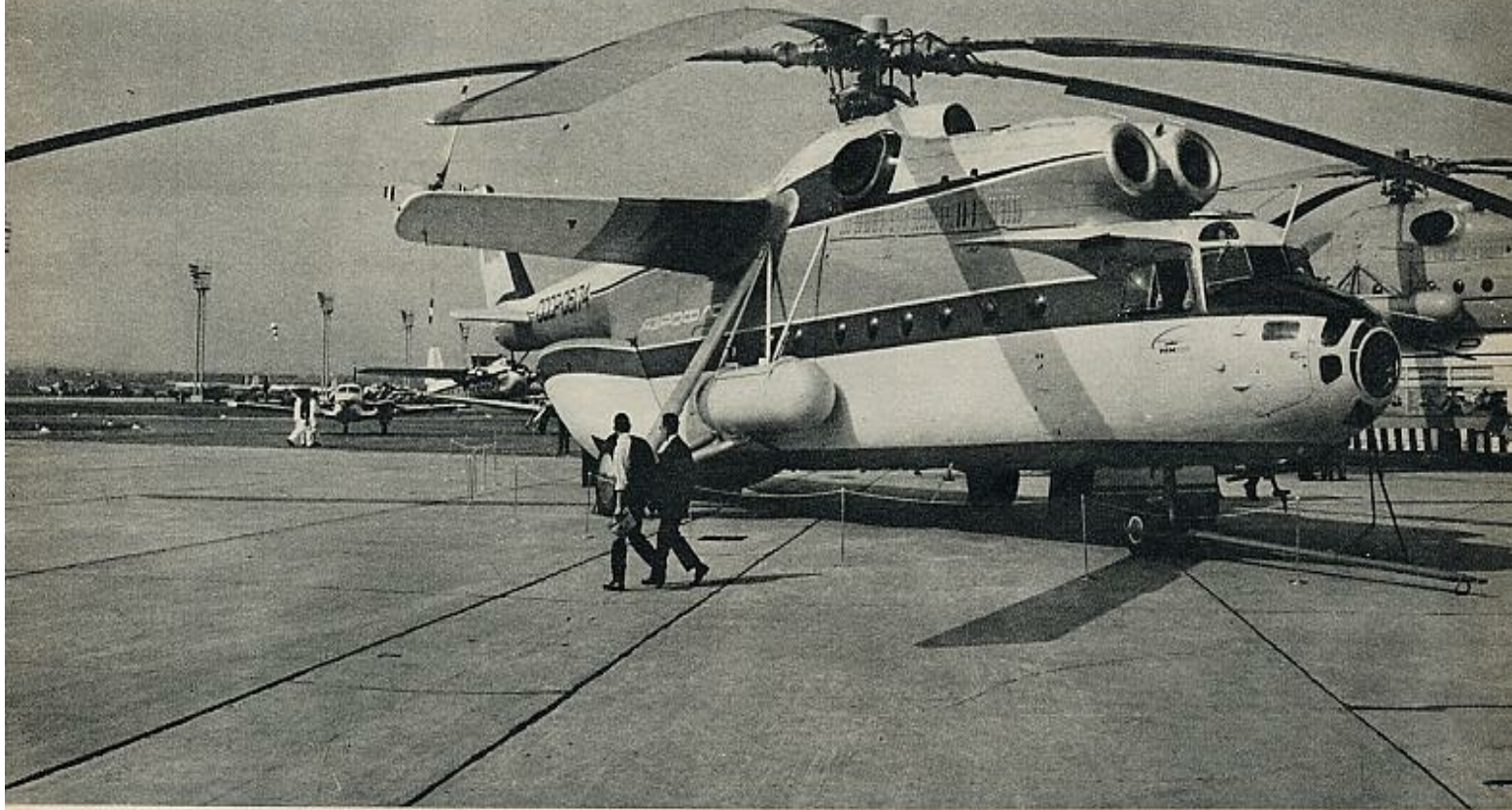
Arriba, por primera vez en Occidente, fue presentado el helicóptero pesado soviético «V 10», que puede transportar 120 pasajeros o 12 toneladas de carga. Abajo, el «Hawkeye», de construcción norteamericana, un biturbina de observación que va provisto de una gran antena de radar que domina todo el aparato.
