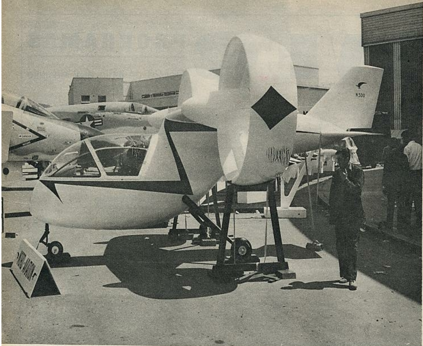
Arriba, la maqueta del audaz aparato «Nord 500», presentada por los norteamericanos. Lleva doble turbina carenada y puede ascender en vertical. Abajo, el «C. 141 Scarlifter», también yanqui. Su carga máxima es de 45 toneladas. La gran atracción americana: exhibición del cohete que lanza las cápsulas Gemini.
