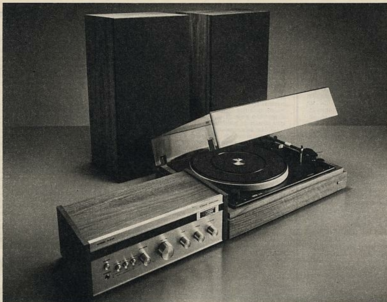
El equipo "Stereo 45" de Superscope: a) Amplificador estereofónico Superscope A-245 (30W de potencia musical). b) Giradiscos manual Vieta G. 90 con motor sincrónico de 16 polos y transmisión por correa. c) Pantallas acústicas MS-101 de dos altavoces. d) Cápsula magnética Shure M-44-7 con aguja esférica de diamante.
