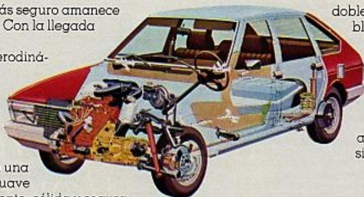
doble circuito de frenos autoajustables y servofreno, suspensión independiente a las cuatro ruedas, y cigüeñal de 5 apoyos, como algunos de sus detalles definitivos de avanzada tecnología.
