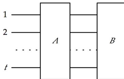
Fig. 2.- El multipolo A absorbe potencia por la puerta 1. La potencia que entrega por la puerta 2 es absorbida por el multipolo B.
