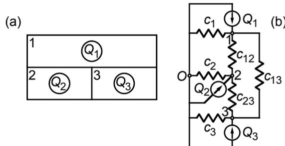
Fig. 3.- a) Edificio con tres fuentes de calor en sus recintos, y b) red de Kirchhoff que describe el flujo estacionario de potencia calorífica.
