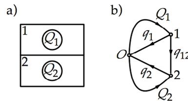
Fig. 2.- a) Edificio de dos recintos. b) Red de Kirchhoff que lo representa en relación con el flujo de calor y la temperatura.
