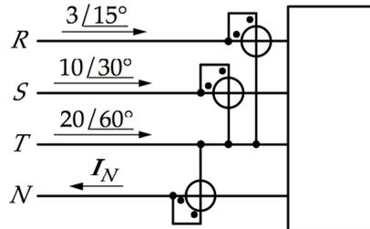
Fig. 10.- Otra forma de medir la potencia de un receptor trifásico de cuatro hilos.
