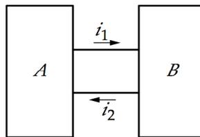
Fig. 4.- En una red de Kirchhoff, formada por acoplamiento de dos dipolos,  $i_1 = i_2$ .
