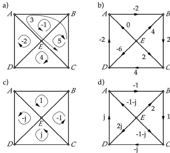
Fig. 14.- Las intensidades de las ramas de b) derivan de las de los bucles de a), y las de d) de las intensidades de malla de c).
