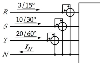
Fig. 9.- Una forma de medir la potencia de un receptor trifásico de cuatro hilos.
