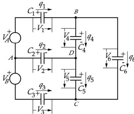
Fig. 6.- Red de Kirchhoff en la que las intensidades son las cargas de los condensadores y las tensiones las tensiones eléctricas entre los nudos.
