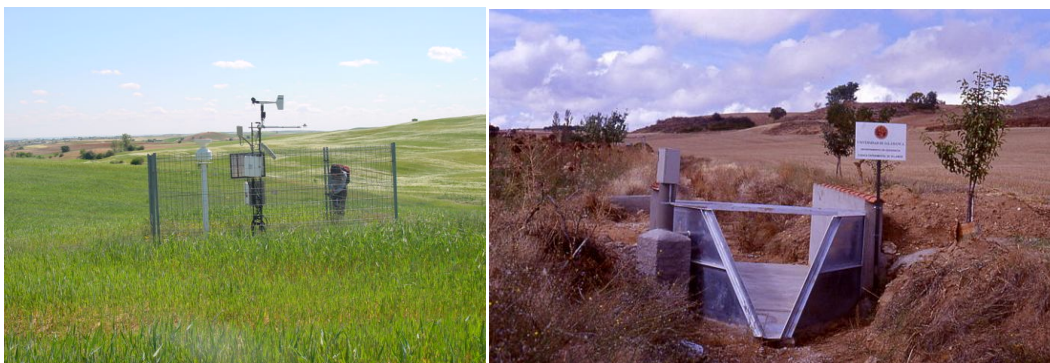
Figura 4-4. Estación meteorológica y aforador de caudal en la cuenca experimental de Villamor.
