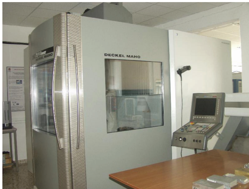
Figura 4.4. Máquina herramienta de Alta Velocidad para procesos de mecanizado
