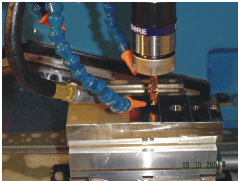
Figura 4.5. Detalle del proceso de Taladrado de Alto Rendimiento
