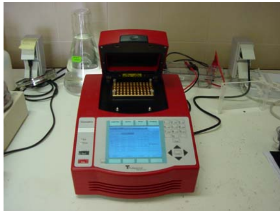
Figura 4. La figura muestra el aparato (termociclador) utilizado por los alumnos para la amplificación del ADN.
