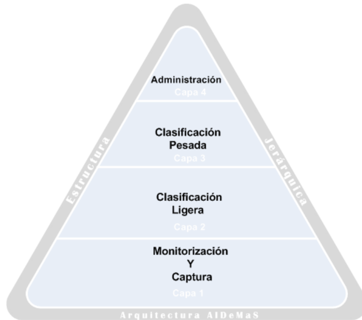
Figura 4.1. Diseño jerárquico de la arquitectura AIDeMaS y funciones definidas
