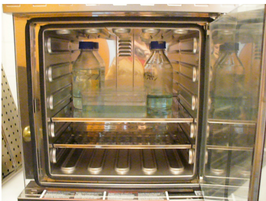
Figura 13. Incubadora Memmert en la que se mantuvieron los embriones de pez cebra a 28,5 °C hasta su sacrificio o hasta la eclosión.
