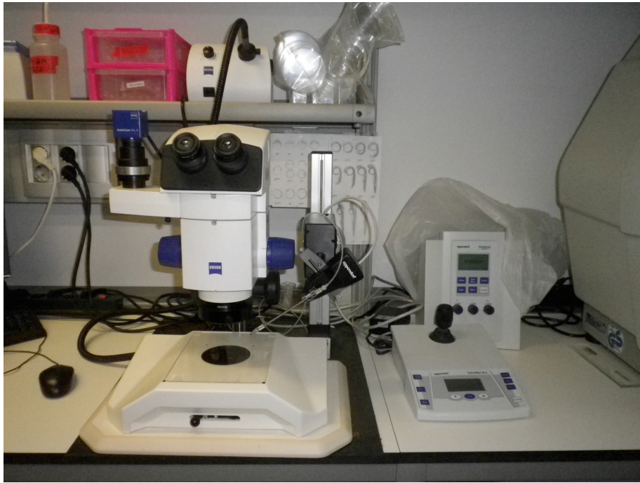
Figura 18. Sistema de microinyección y micromanipulación (Eppendorf) para embriones, acoplado un estereoscopio (Zeiss Discovery V8).
