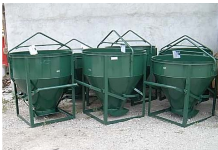
Cubilote de vertido de hormigón
