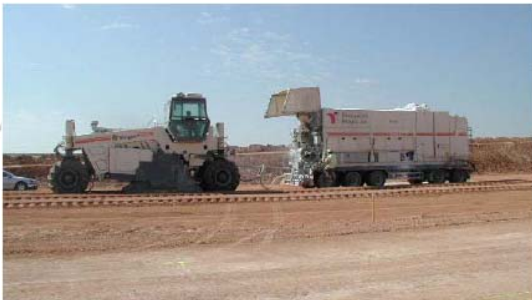
Equipo de mezclado y estabilización (vía húmeda )
