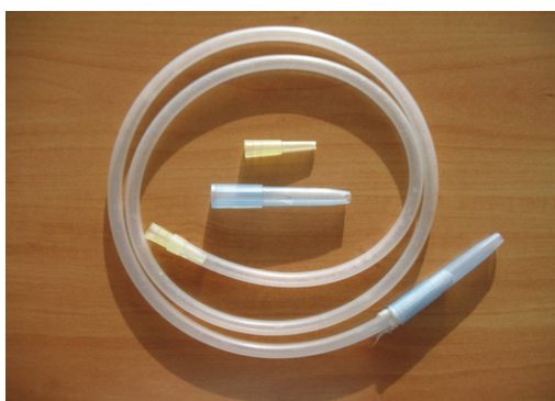
Figura 2.17. Aspirador entomológico empleado para la captura de individuos adultos de A. daci . En el centro de la imagen, puntas de pipeta utilizadas como extremos de este instrumento (se aspira por el extremo amarillo y los individuos quedan atrapados en el extremo azul). Fotografía: Francisco Beitia.
