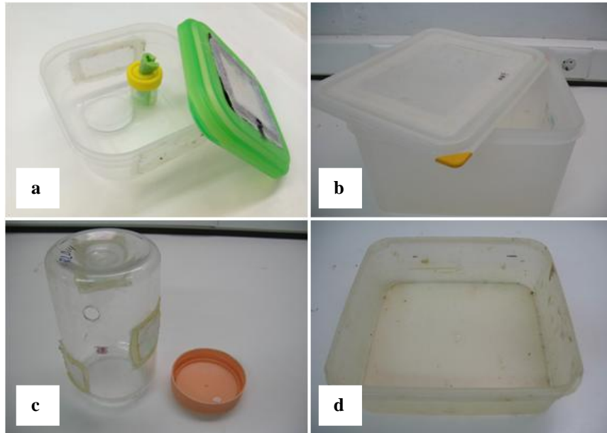
Figura 2.11. Recipientes utilizados para la evaluación de la actividad del parasitoide A. daci : a) Caja de emergencia modificada para ensayos de actividad parasitaria. En la tapa (de color verde) se puede apreciar una ventana de tela rodeada de cinta magnética; b) Recipiente con ventana superior de muselina, usado para la evolución de huevos sembrados en dieta y para la oferta de fruta infestada en laboratorio; c) Cilindro de plástico, con ventanas laterales de tela, empleado en ensayos de longevidad y de acción parasitaria en campo; d) Recipiente usado para disponer fruta cebo en campo en el seguimiento de poblaciones naturales de A. daci . Fotografías: Luis de Pedro.
