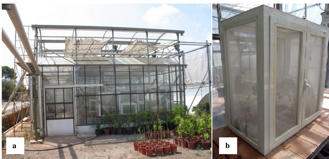
Figura 2.4. Invernadero de cristal puesto a disposición de la Unidad de Entomología del IVIA: a) Vista externa del invernadero; b) Jaulón con borde de plástico utilizado para la realización de ensayos en condiciones de aislamiento, y localizado en la cabina 3 del invernadero. Fotografías: Luis de Pedro.
