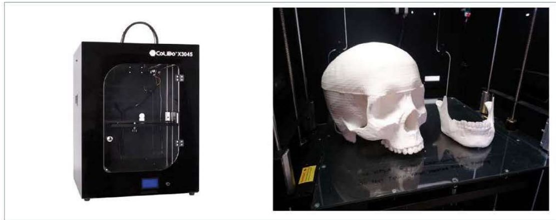
Figura 4. Impresora modelo Colido X3045 utilizada para la fabricación aditiva de las piezas craneales.
