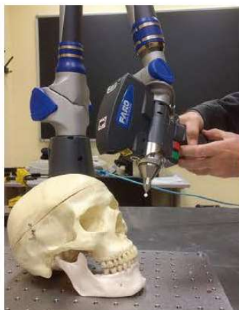
Figura 1. Digitalización de una pieza ósea con el escáner modelo FaroArm Scan Platinum.
