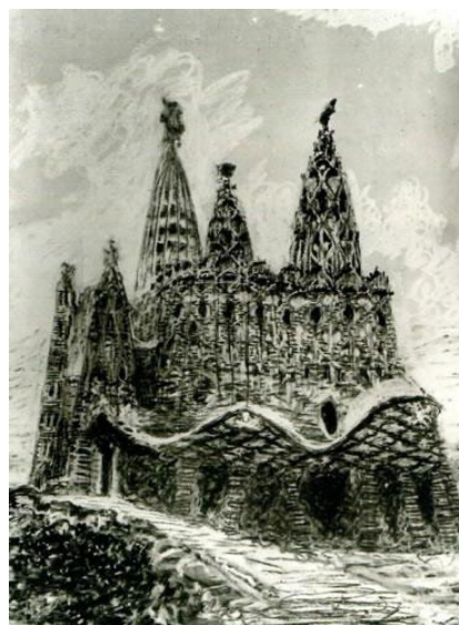
Fig. 190. Fotografía de la maqueta expuesta en el apartado de la catenaria anterior, girada 180 grados y repintada encima con una vista del ábside de la iglesia de la Colonia Güell. Fuente: GIRALT-MIRACLE, D. Gaudí. La búsqueda de la forma... , p. 69.
