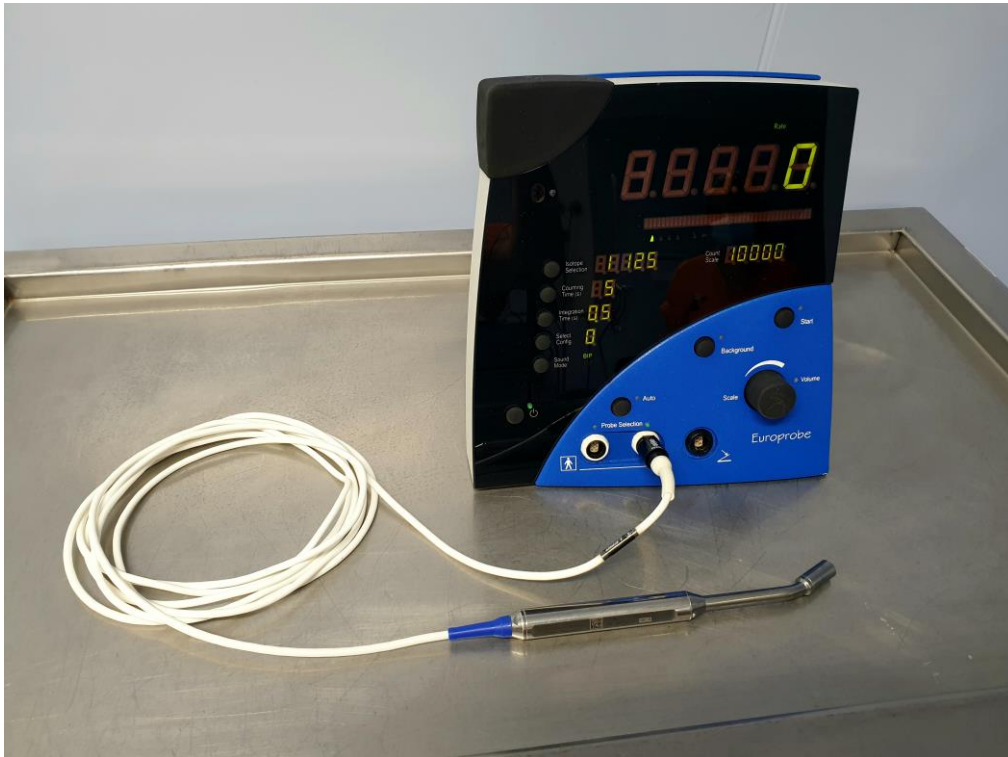
Figura 19. Sonda gamma EuroProbe 3 ® (Eurorad SA, Francia) configurada para detectar 125 I
