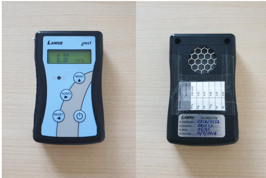
Figura 6. Detector Geiger-Müller compacto Eris 1C (LAMSE, Madrid, España)
