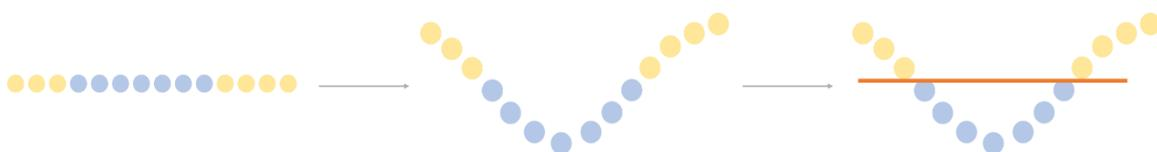
**Figura 17. Representación esquemática de una máquina de vectores de soporte.** En el conjunto de datos original, los datos se muestran de una forma lineal. La máquina de vectores de soporte proyecta las observaciones en una dimensión superior, y posteriormente encuentra un hiperplano que las separa.
