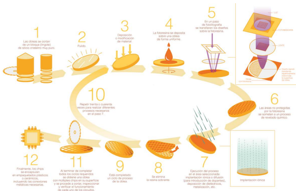
Figura 1. Ciclo de fabricación de un circuito integrado. La fabricación de un chip es un proceso iterativo que involucra diferentes pasos (deposición de dieléctricos, grabado, litografía,
