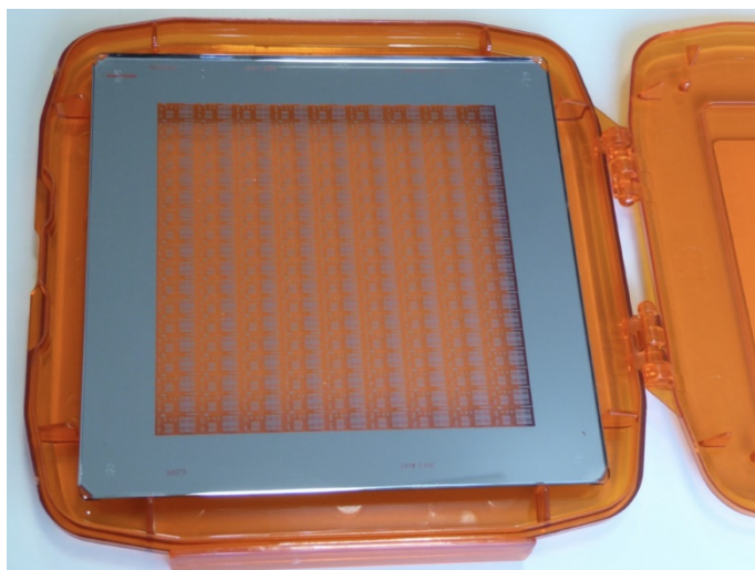
Figura 3. Máscara de Fotolitografía cedida por el Instituto de Microelectrónica de Barcelona. Centro Nacional de Microelectrónica. Barcelona. Máscara de fabricación de diodos PIN en sustratos de Carburo de Silicio (SiC). Definición de los contactos metálicos.
